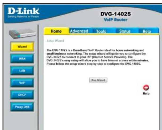
Figura 3 - Hiperphone - Por padrão a configuração de IP do ATA está definida como automática. Caso seja necessário alterar, clicar em WAN (segunda opção à esquerda na guia HOME) e fazer as alterações necessárias.
