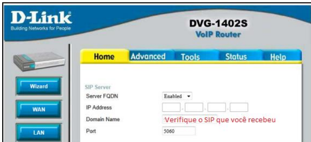
Figura 4 - Hiperphone -Para configurar o equipamento para realização de chamadas, clicar em VOIP depois em Server Configuration e preencher os campos, conforme figuras.
